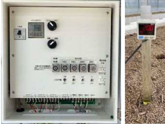
左：灌水指令制御盤 右：デジタルセンサ (テンション (pF) メーター，土壤水分張力)
